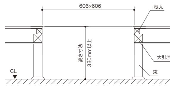
③ 補助根太(現地調達)を床面から37.5mmの位置に取り付けてください。また、補助根太に本体支持用の本体吊金具を取り付けてください。本体吊金具は補助根太の天面にそろえて、本体吊金具に付属しているねじで固定してください。
