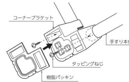
コーナーブラケットと手すり本体のねじ穴を合わせるように、手すり本体をコーナーブラケットにさしこみタッピングねじで確実に固定し、グラツキが無い事を確認する。その後、ブラケットに樹脂パッキンをはめ込む。
