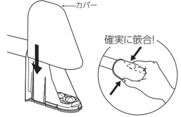
エンドブラケットの上方より、カバーを挿入する。カバーの両サイドを押さえ、ブラケットに確実に嵌合させる。
