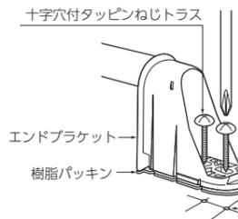
樹脂パッキンをエンドブラケットにはめ込み、下穴にねじ穴を合わせ、十字穴付きタッピングねじトラスで壁に確実に固定し、グラツキが無い事を確認する。
