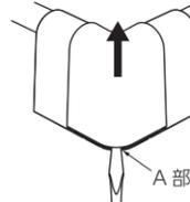
2 コーナーブラケットカバーの下端部 (B 部) を指で持ち①方向に引きながら上方 (②方向) にコーナーブラケットカバーを持ち上げて、コーナーブラケットからカバーを取りはずす。
