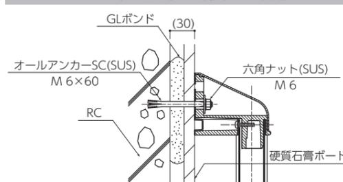
取付方法 付属の取付アンカーを使用する場合
