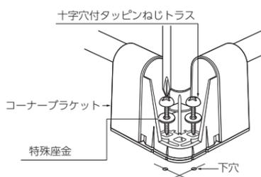
ねじ穴を下穴に合わせ、特殊座金、タッピングねじトラスの順で、壁に確実に固定し、グラツキが無い事を確認する。
