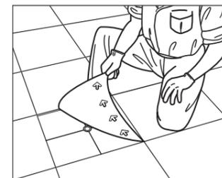
2 ハンドルを用いてACロックを外してください。ネジをゆるめる要領でACロックを反時計回りにまわして外してください。
