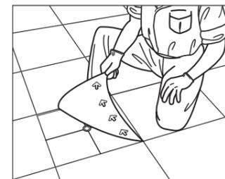
2 ハンドルを用いてACロックを外してください。ネジをゆるめる要領でACロックを反時計回りにまわして外してください。
