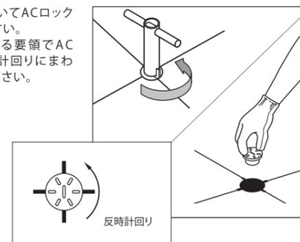
3 パネルはAC開口カバーを外した開口部に手を入れ、床パネルを垂直に持ち上げて取り外してください。
